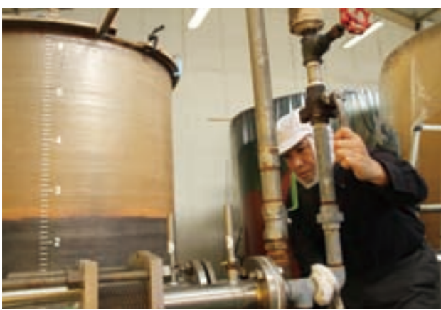
▲火入れの作業で中央の温度計に注視しながら微妙な温度調整をする永田さん。醤油の香り・味が決まる瞬間なのだ。
